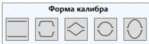
Рис. 1. Формы калибров сортового проката в САПР Калибер
