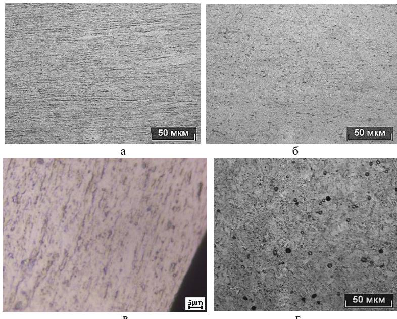
Рис. 1. Микроструктура grade 4 в продольном (а) и поперечном (б, в, г ) сечении после асимметричной прокатки при относительном обжатии 82% (а,б), АП после отжига при 450 С (в), после прокатки с током (г)
