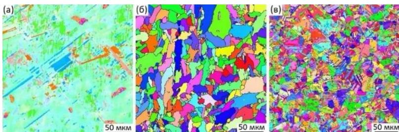
Рис. 1. Микроструктура сплава системы Со-Ср-Мо (центр) в литом состоянии
