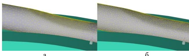
Рис. 1. Метод двойной сетки для моделирования сортовой прокатки:
