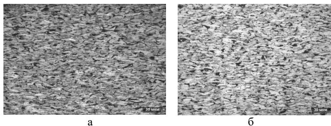
Рис 1. Микроструктура стали 20:
