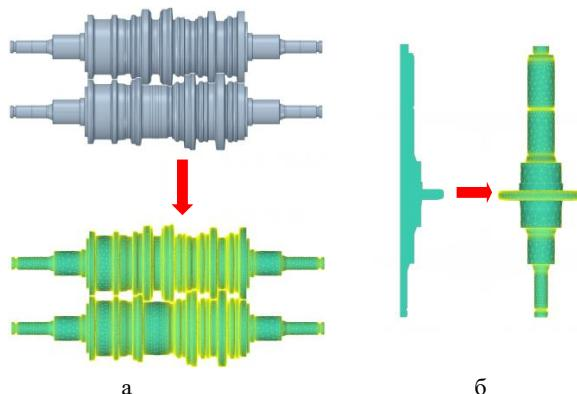
Рис. 2. Импорт геометрии для создания КЭ-моделей валков в QForm:
