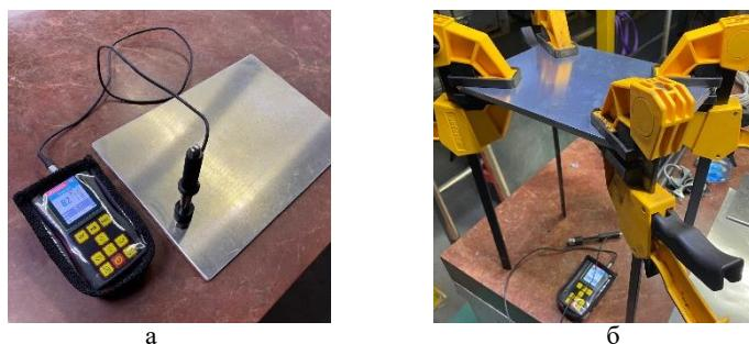
Рис. 1. Фотографии процесса измерения твердости пластин:
