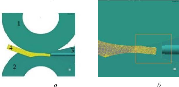
Рис. 1. Модель процесса СПП (а) и конечно-элементная сетка заготовки (б)
