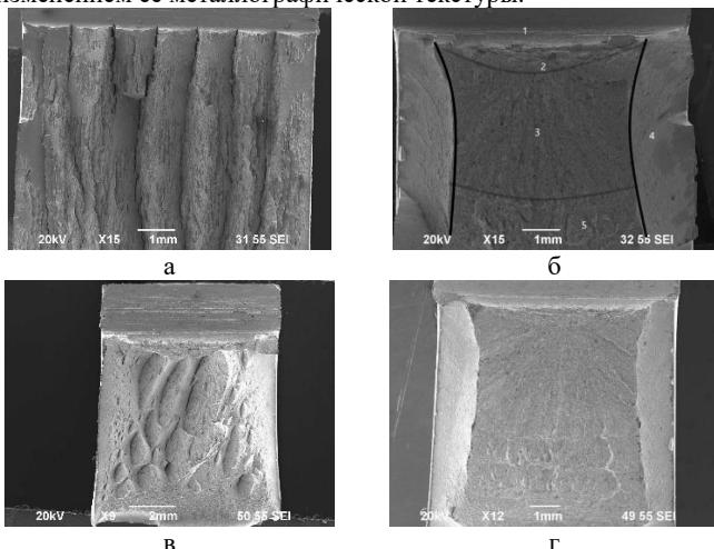
Рис. 1. Изломы образцов при температуре ХВП:
