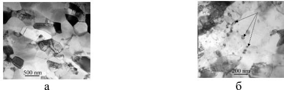
Рис. 2. Микроструктура КЗ (а) и УМЗ титана (б) после прокатки до  $\varepsilon = 88\%$  кратковременного in-situ отжига при 700 °C (в, г)
