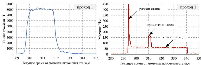
Рис. 1. Экспериментальные кривые усилия и момента прокатки
