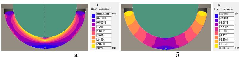
Рис. 1. Распределение степени деформации сдвига  $D$  (а) и показателя напряженного состояния  $K$  (б) по профилю полусфера
