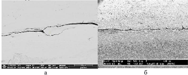
Рис. 1. Дефекты в районе сварного шва в виде трещины на внутренней поверхности трубы (а) из сплава ПдСр60-40 и складки на наружной поверхности (б)
