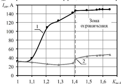
Рис. 1. Зависимости действующих значений токов двигателей от коэффициента асимметрии:
