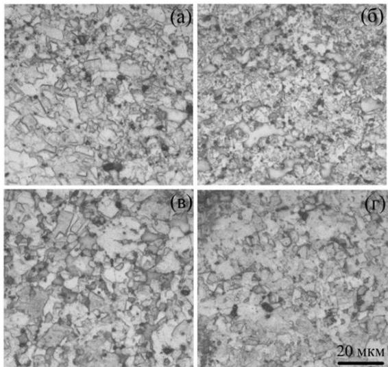
Рис. 1. Микроструктура срединного слоя после трех (а, в) и шести (б, г) полных циклов при 400°C (а, б) и 500°C (в, г)
