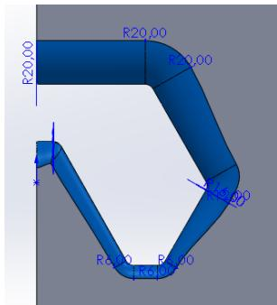
Рис. 2. Радиусы скруглений канала матрицы с переменным скруглением
