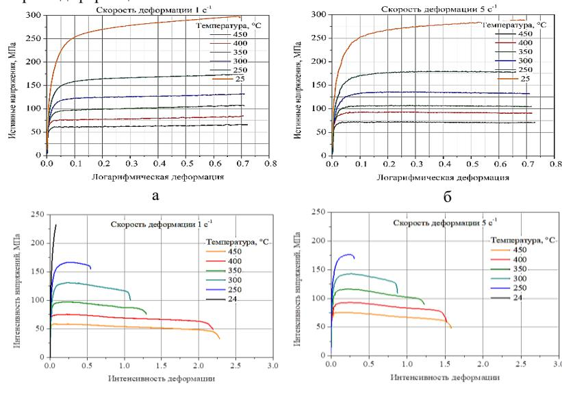
Рис. 1. Результаты испытаний образцов из сплава 1441 на сжатие при температурах 450, 400, 350, 300, 250 и 25°C со скоростью деформации  $1 \text{ c}^{-1}$  (а) и  $5 \text{ c}^{-1}$  (б); результаты испытаний образцов на кручение при температурах 450, 400, 350, 300, 250 и 24 °C со скоростью деформации  $1 \text{ c}^{-1}$  (в) и  $5 \text{ c}^{-1}$  (г)
