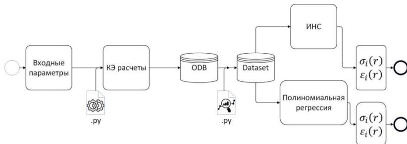
Рис. 1. Схема подготовки ML моделей для определения остаточных напряжений и накопленных деформаций
