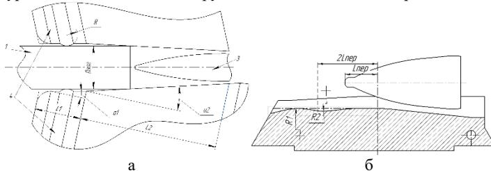
Рис. 1. Измененный профиль валка и линейки прошивного стана:
