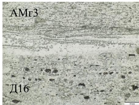
Рис. 1. Поперечный шлиф слоистого композита “АМГ3/Д16/АМГ3”
