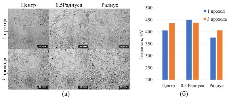
Рис. 1. Микроструктура по сечению прутка (а);
