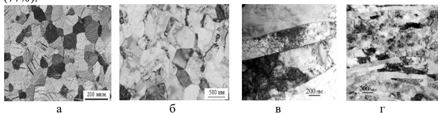
Рис. 1. Микроструктура титана до (а, б) и после (в, г) прокатки  $\varepsilon = 81\%$
