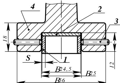
Рис. 1. Оправки машины трения, с зажатой в ней парой трения:
