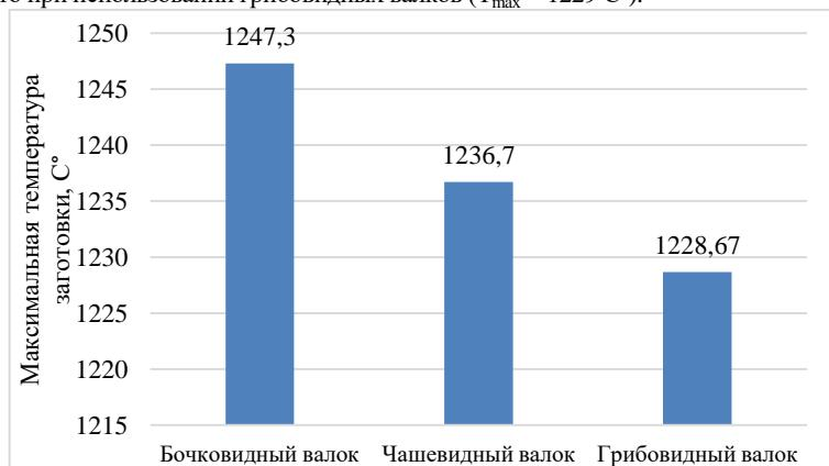
Рис. 1. Значения максимальной температуры заготовки при прошивке с использованием бочковидных, чашевидных и грибовидных валков
