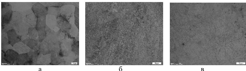
Рис. 1. а) Структура в исходном состоянии, б) Структура после ИПДК 2 оборота, в) Структура после ИПДК 10 оборотов.
