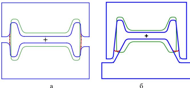
Рис. 2. К методике проектирования в «Универсальном параметрическом калибре» на примере двутавровой балки 14Б2 против хода прокатки:
