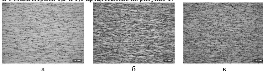
Рис. 1. Микроструктура сплава 1545К после горячей прокатки:
