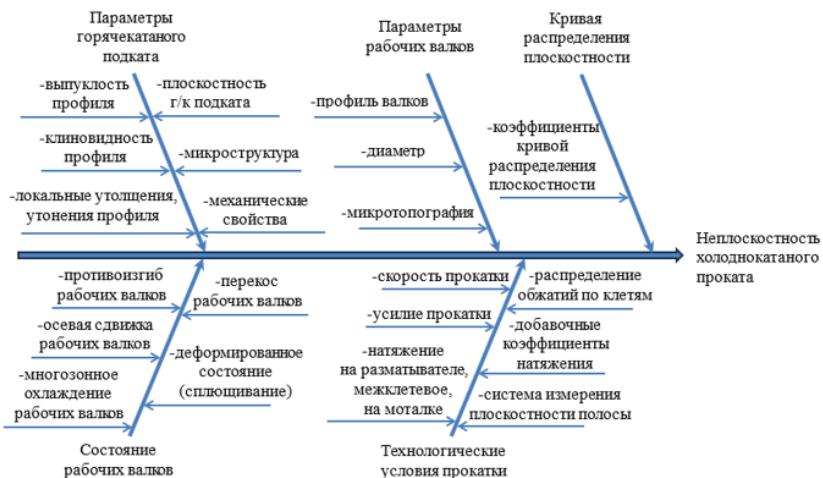
Рис. 1. Параметры, влияющие на плоскостность холоднокатаного проката
