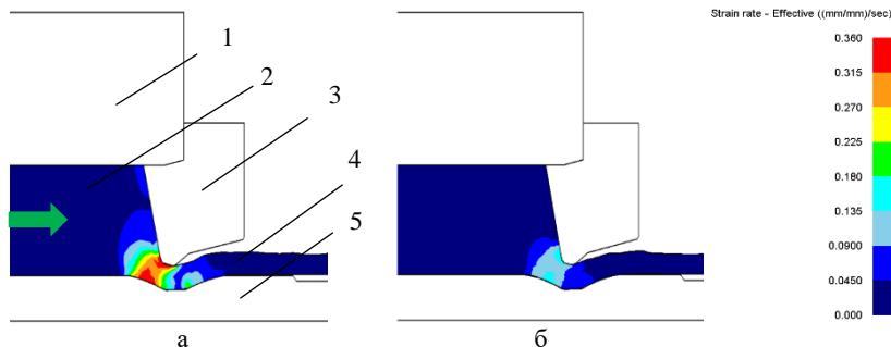
Рис. 1. Распределение скорости деформации в ОД при прессовании протектора согласно классической технологической схеме (а):
