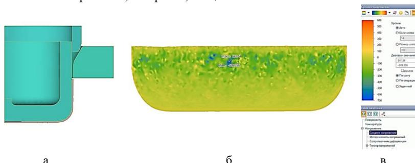
Рис. 1. Сборка штампового инструмента (а), распределение средних напряжений после снятия нагрузки в конце 1 перехода (б) и шкала параметра (в)
