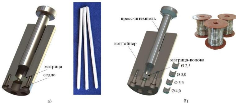
Рис. 1. Технологическая оснастка для экструзии:
