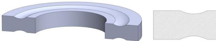
Рис. 1. Дефект поперечного сечения кольца типа «крыльчатый хвост»
