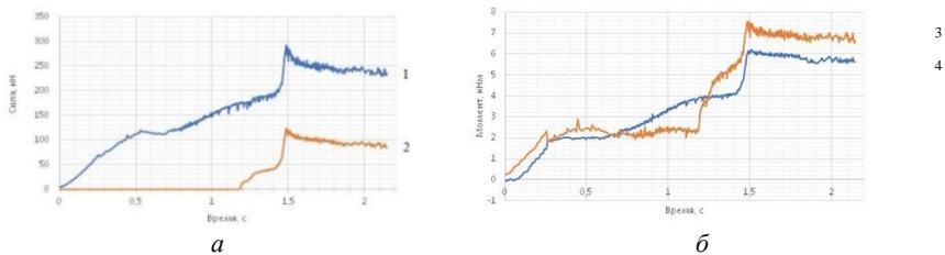
Рис. 2. Изменение по длине очага деформации сил (а), действующих на валки (1) и на матрицу (2), и моментов (б) на валке с канавкой (3) и валке с выступом (4)
