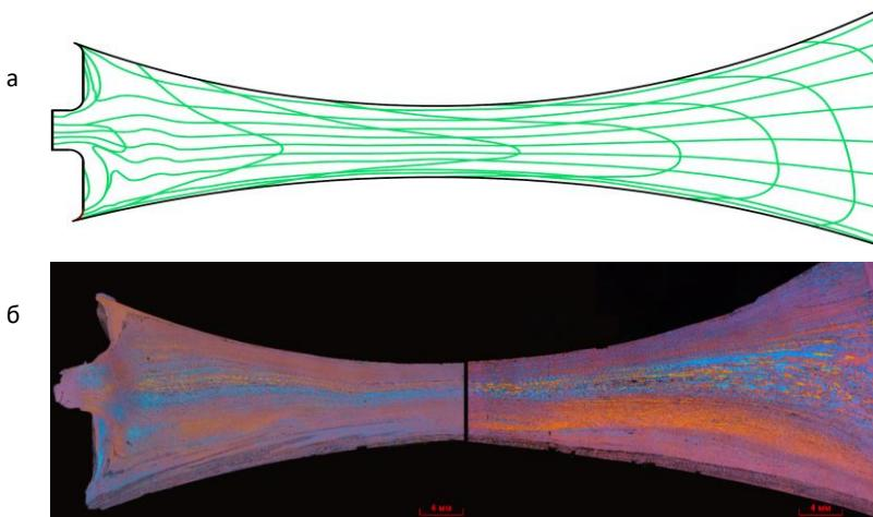
Рис. 2. Характер течения металла в процессе БПП:
