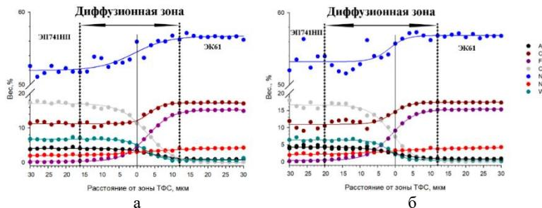
Рис. 1. Распределение легирующих элементов в зоне ТФС сплавов ЭК61 и ЭП741НП:
