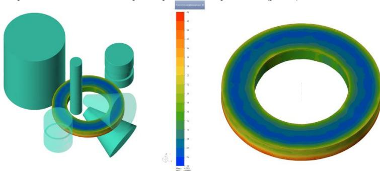
Рис. 3. Пластическая деформация кольца при моделировании
