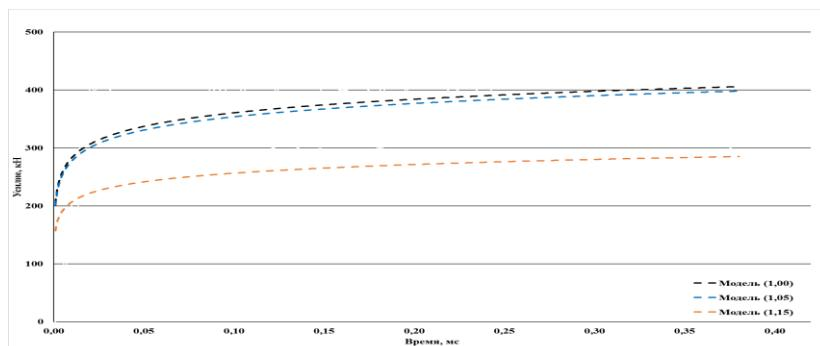
Рис. 2. Результаты компьютерного моделирования влияния симметрии и скоростной асимметрии на усилие прокатки с толщины  $h_0 = 2$  на  $h_1 = 1,4$  мм
