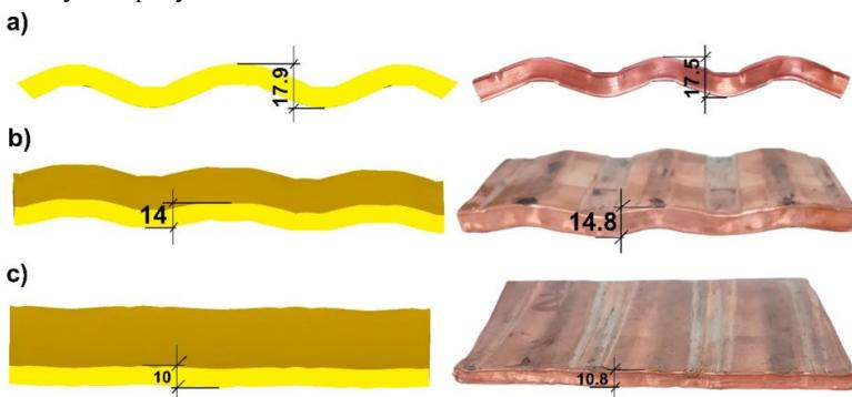
Рис. 1. Сравнение формы медной заготовки при моделировании и эксперименте:
