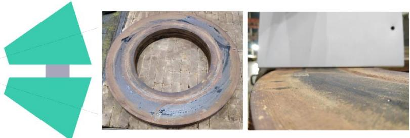
Рис. 4. Результат моделирования и фактической раскатки
