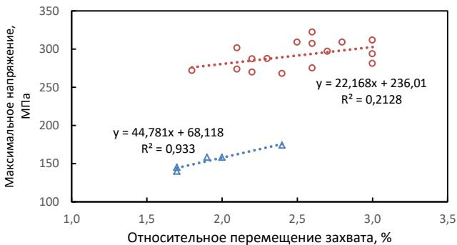
Рис. 1. Графики нагружения правильно-растяжной машины при обработке сплава B95, точки – опытные данные
