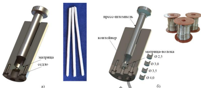
Рис. 1 – Технологическая оснастка для экструзии: а) прутков; б) проволоки
