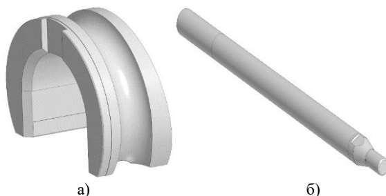
Рис.1 – Калибр (а) и оправка (б), построенные по результатам проведенных расчетов калибровки инструмента стана ХПТ-2-55 для прокатки труб из алюминиевого сплава Д16
