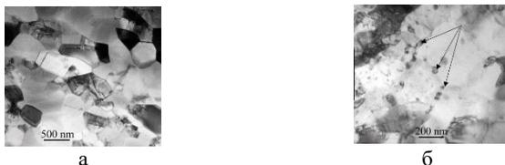
Рис. 2. Микроструктура КЗ (а) и УМЗ титана (б) после прокатки до  $\epsilon = 88\%$  кратковременного in-situ отжига при 700 °С (в, г)
