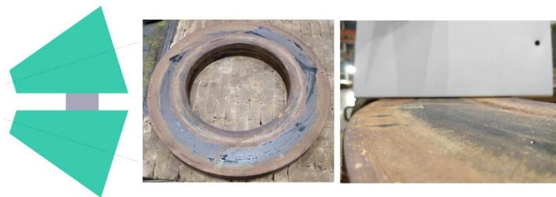
Рис. 4. Результат моделирования и фактической раскатки
