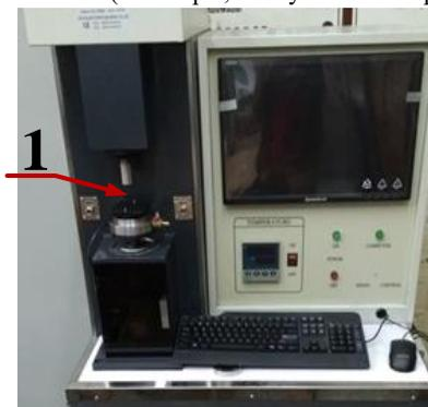
Рис. 1. Внешний вид машины трения: 1 – место установки узла трения УМТ
