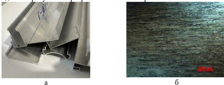
Рис. 1. Вид отходов прессового производства (а) и микроструктура прутка диаметром 9 мм из алюминиевого сплава АД35, полученного методом БПП (б)
