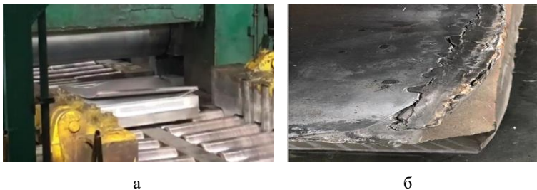
Рис. 2. Изгиб конца планшета вверх (а), растрескивание раската по узким граням в местах приварки планшета (б)
