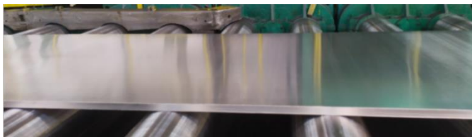
Рис. 1. Полоса из силумина AlSi10Mg с плакирующим слоем из сплава А5
