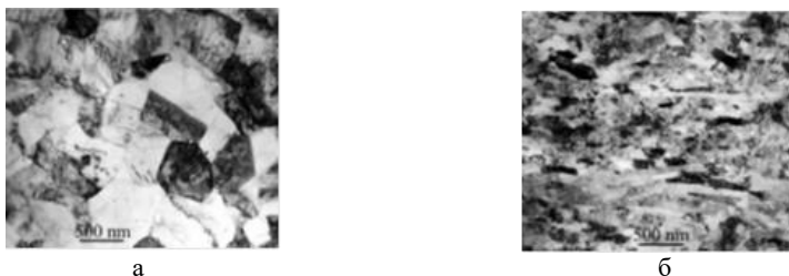
Рис.2. Микроструктура УМЗ титана до (а) и после прокатки \epsilon = 88\% (б) [3]
